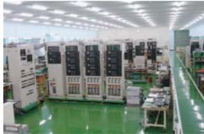
DCモータ自動検査装置
