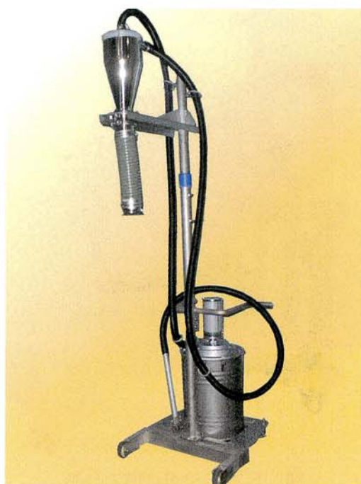
■ 原料投入機の外観
