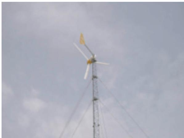
図3 ファールリング制御 (強風時)
