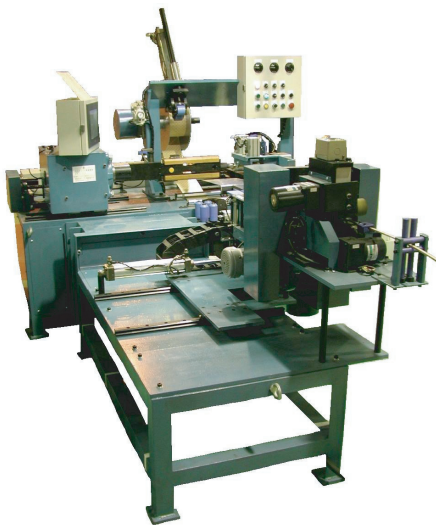
図1 低圧コイル巻線機外観
