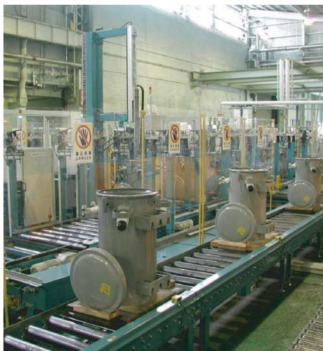
図2 柱上変圧器新生産ライン(完成試験ライン)
