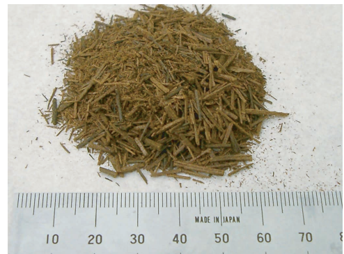
図5 破碎後の廃木材
