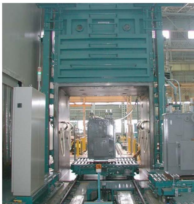
図2 真空注油装置および自動搬送台車
