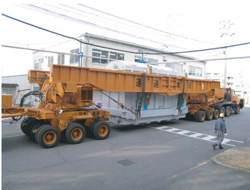
出荷を待つ20万kVA変圧器
