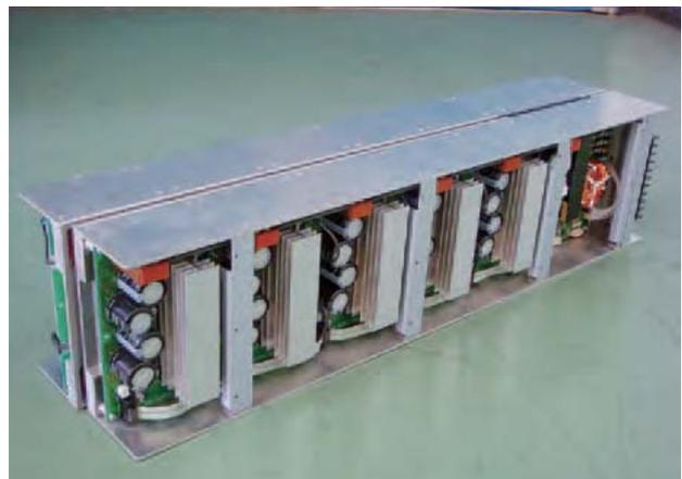
図11 3kW 大容量非接触給電装置の外観図
