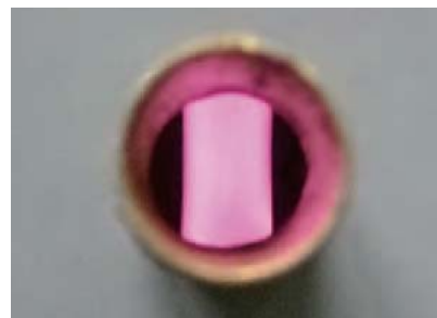
図2 非平衡プラズマの外観(酸素プラズマ)
