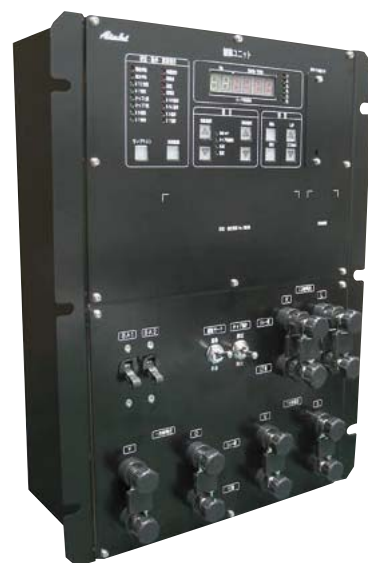
■ 逆潮流対応型SVR用制御ユニットの外観
