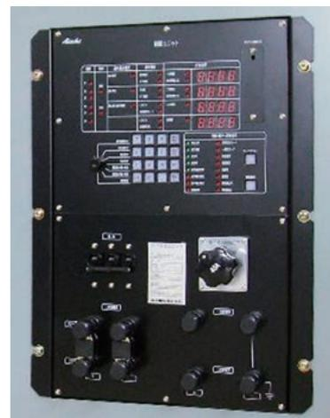
■ 制御ユニット 操作・表示パネルの外観
