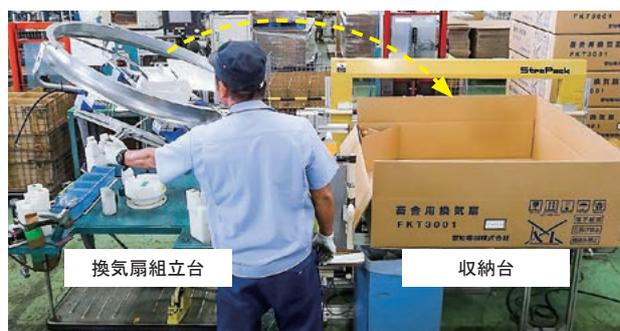
図7 換気扇反転(一人作業)
