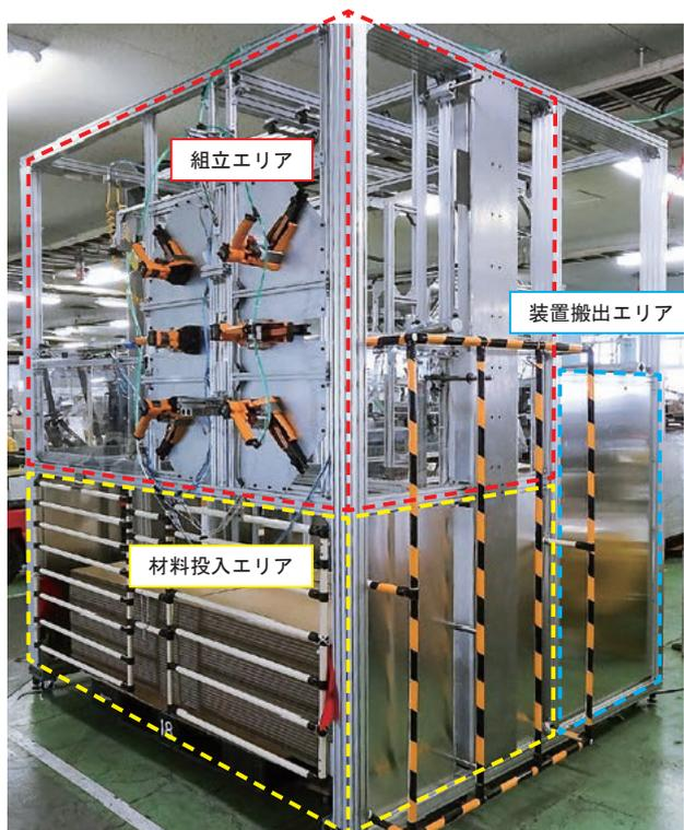
図3 自動製函装置外観
