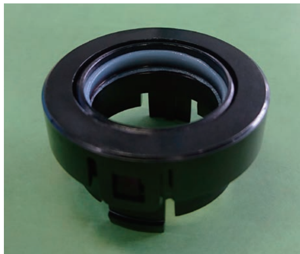
図6 設備によるグリース塗布状態
