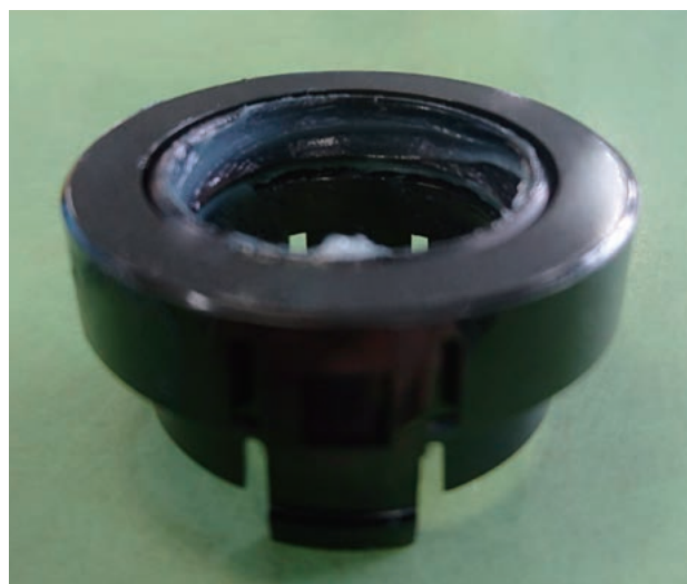
図5 刷毛塗りによるグリース塗布状態
