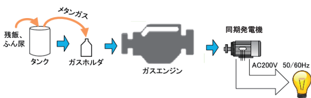
図3 東南アジアでのバイオガスを使った発電構成例
