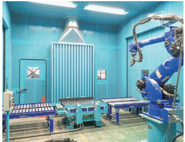
図4 溶射処理装置の全景
