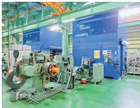
図2 導入したモータコア打抜きプレス機の外観
