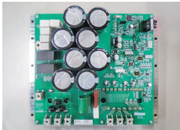
図2 開発品インバータモジュールの外観
