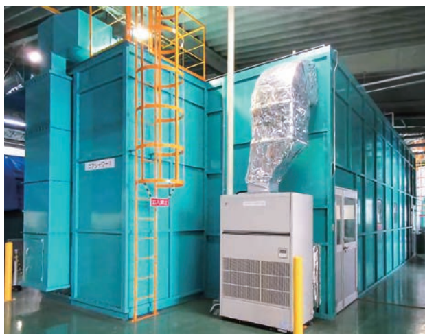
図1 上塗り塗装設備外観
