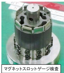
図1 従来の手作業のゲージ検査
