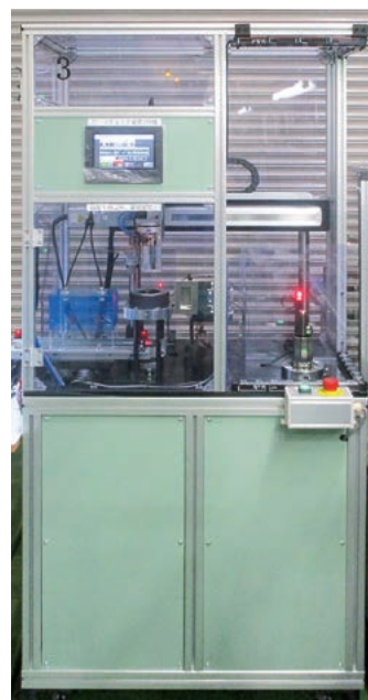
図2 自動ゲージ検査装置全体
