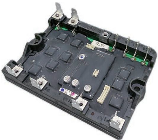
■ ショーケース圧縮機用駆動インバータ外観
