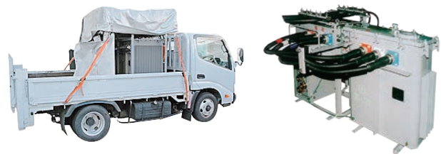
図3 従来の変圧器車および工事用変圧器
