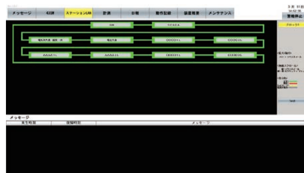
図15 SCADA装置「ステーションLAN」画面
