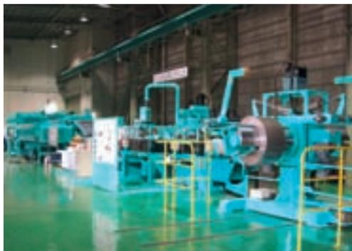
大形変圧器製造工程における老朽設備の更新にあたり、生産性向上、リードタイム短縮を目的に、鉄心切断・加工の自動化のための新設備を導入しました。
