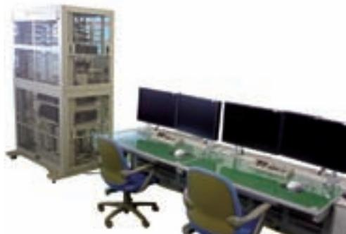
現行の配電線自動化親局装置の経年更新に伴い、新機能を付加した新型の親局装置を開発しました。
