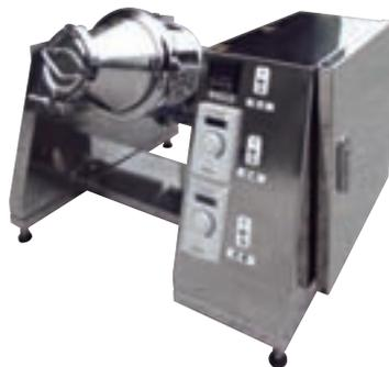
医薬品向け粉体混合機の新製品として、「低発塵」「相互汚染防止」「丸洗い洗浄可能」の3つの特長を持った「ロッキングミキサーサニタリータイプ」を開発し、市場投入しました。
