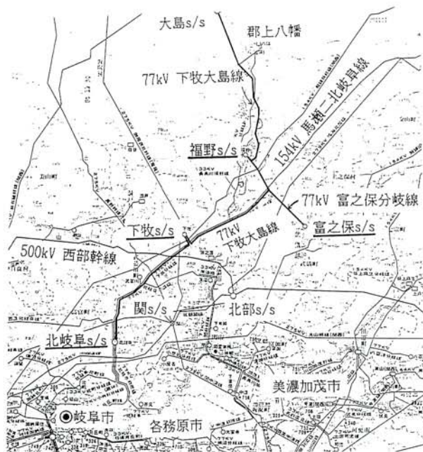
図2/福野変電所送電線経過図
