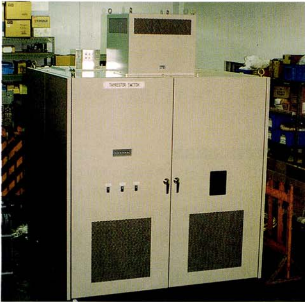
図20 6kV4kA高圧電流スイッチ
