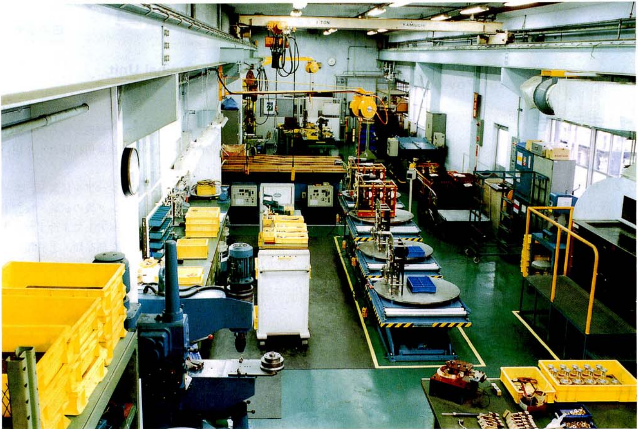
自動電圧調整器用タップ選択開閉器組立ライン Renewed assembly workshop of SVR switches
