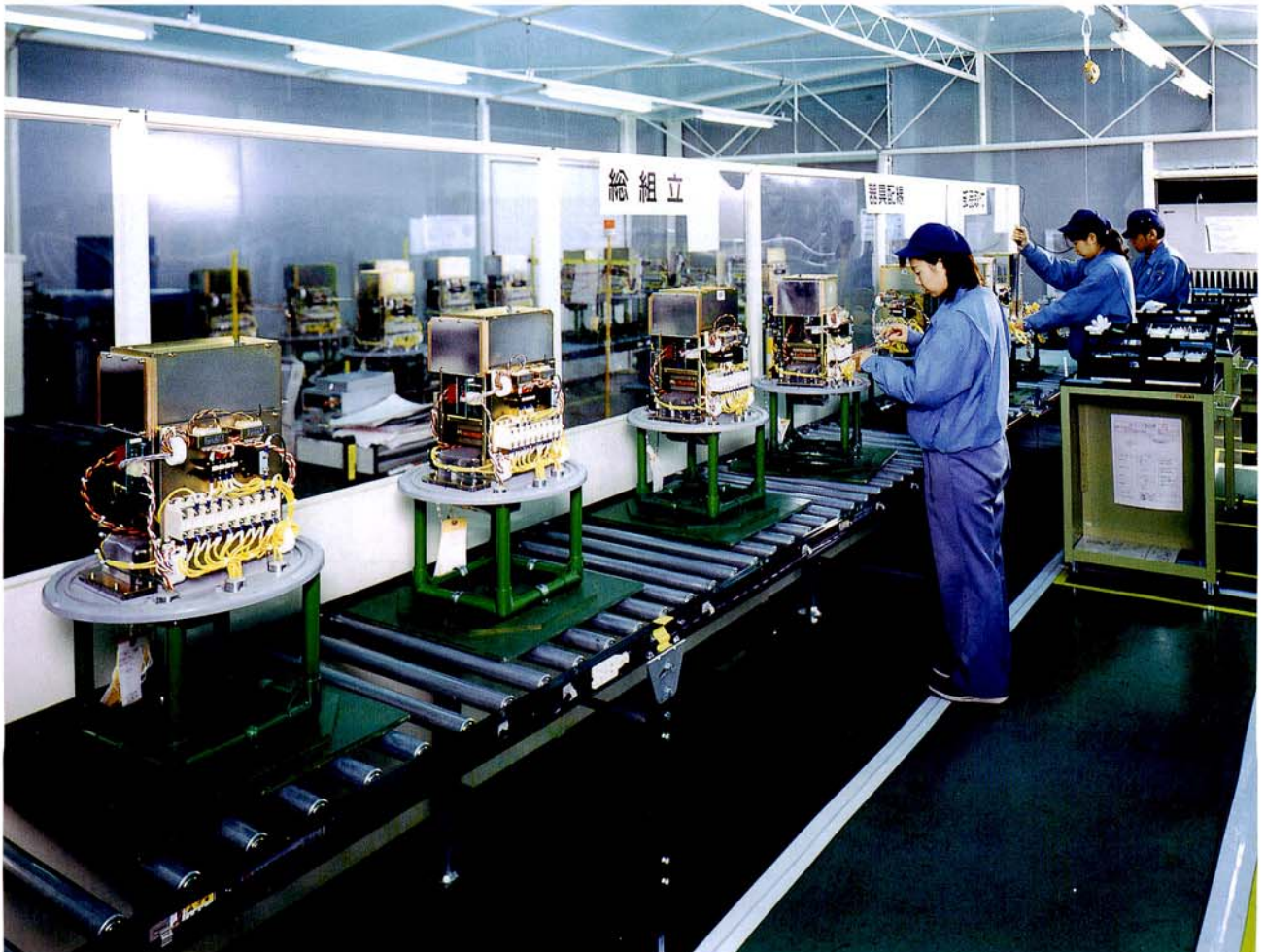
子局組立検査ライン Assembly & testing workshop
