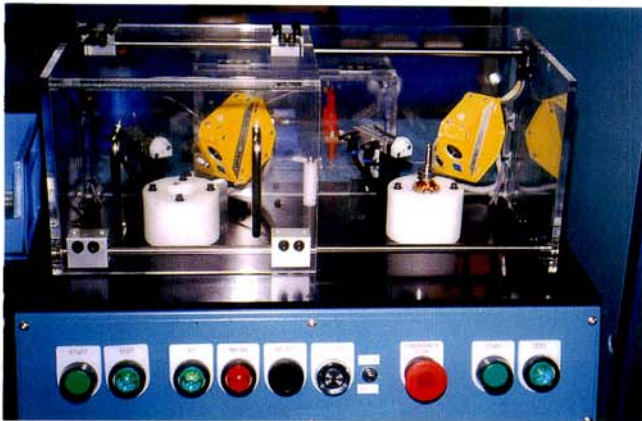
ワークセット部（電機子試験機） Armature winding tester
