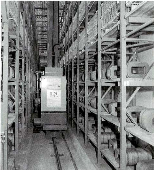
図4/立体自動保管装置
