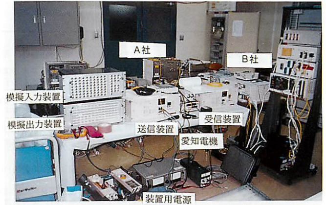
図8 異メーカー対向試験風景 Fig.8. A view of different maker test
