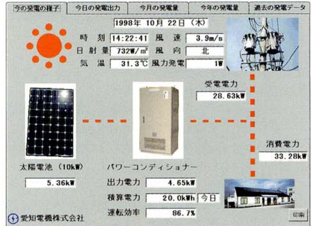
■ 太陽光発電システムの表示画面
