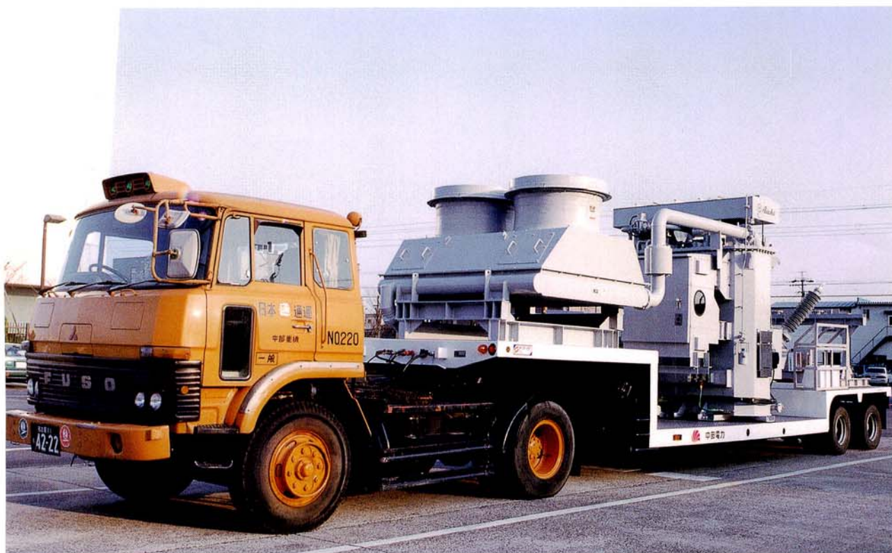
移動用 77kV 15MVA 負荷時タップ切換変圧器 本誌19頁参照
