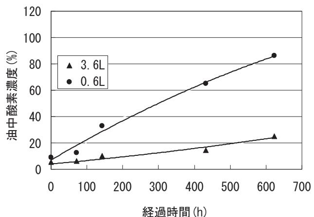
図6 体積による油中酸素濃度の経時変化
