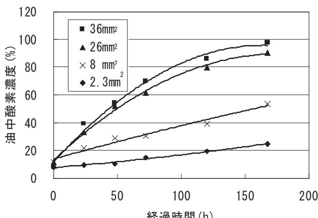
図5 接触面積による油中酸素濃度の経時変化
