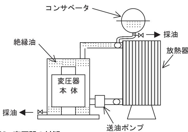
図1 变压器の外観
