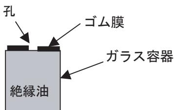
図4 隔膜ゴム損傷模擬試験容器
