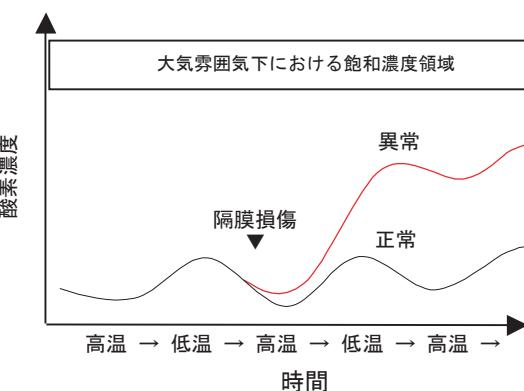
図3 隔膜式変圧器の酸素濃度の変動のイメージ
