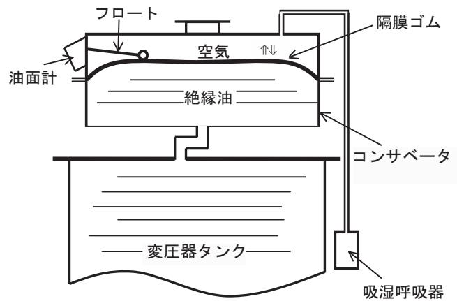
図2 隔膜式コンサベータ
