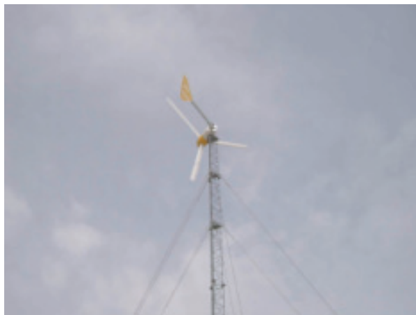
図3 ファーリング制御 (強風時)
