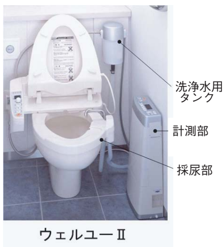
図1 ウェルユーⅡ尿糖検査機のトイレ設置例
