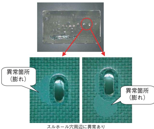
図9 内部状態検査 (パルコート処理)
