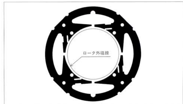
図8(b)/クマトリモータのステータコア (4極レラクタンスギャップ付インナロータ構造) Fig. 8(b)/Stator core of shaded pole motor
