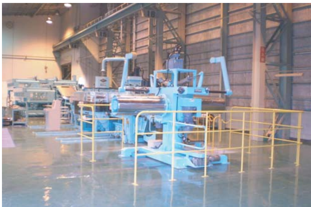
図2 鉄心自動切断・加工機外観
