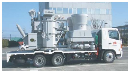
■ 移動用負荷時タップ切換変圧器外観
