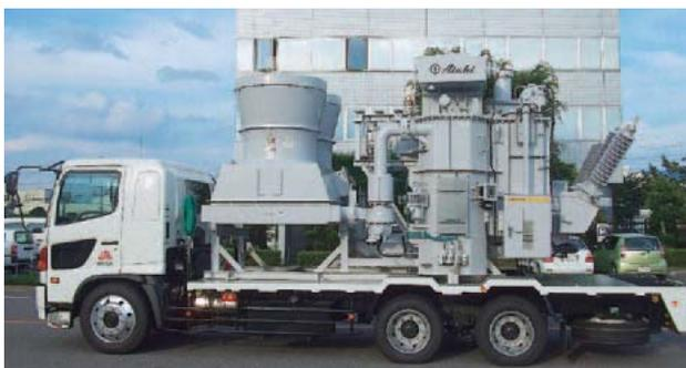
■ 移動用負荷時タップ切換変圧器外観(77-33kV 10MVA)
