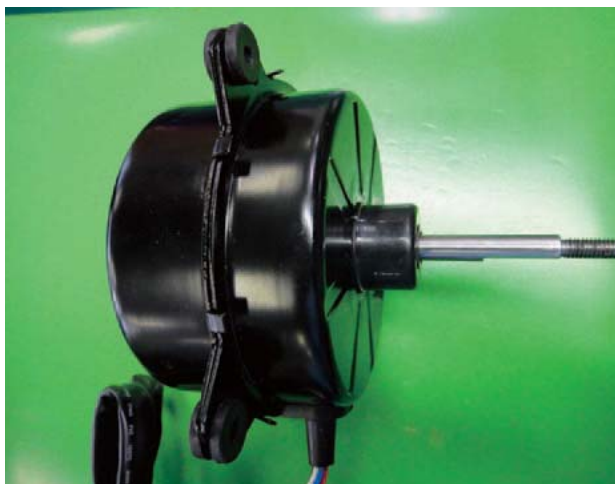
図4 機種D：ルームエアコン室外機用ファンモータ
