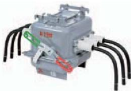
高圧需要家構内での地絡事故に対し、自動的に電路を切り離し他の需要家への波及を防ぐ開閉器として使用されます。
