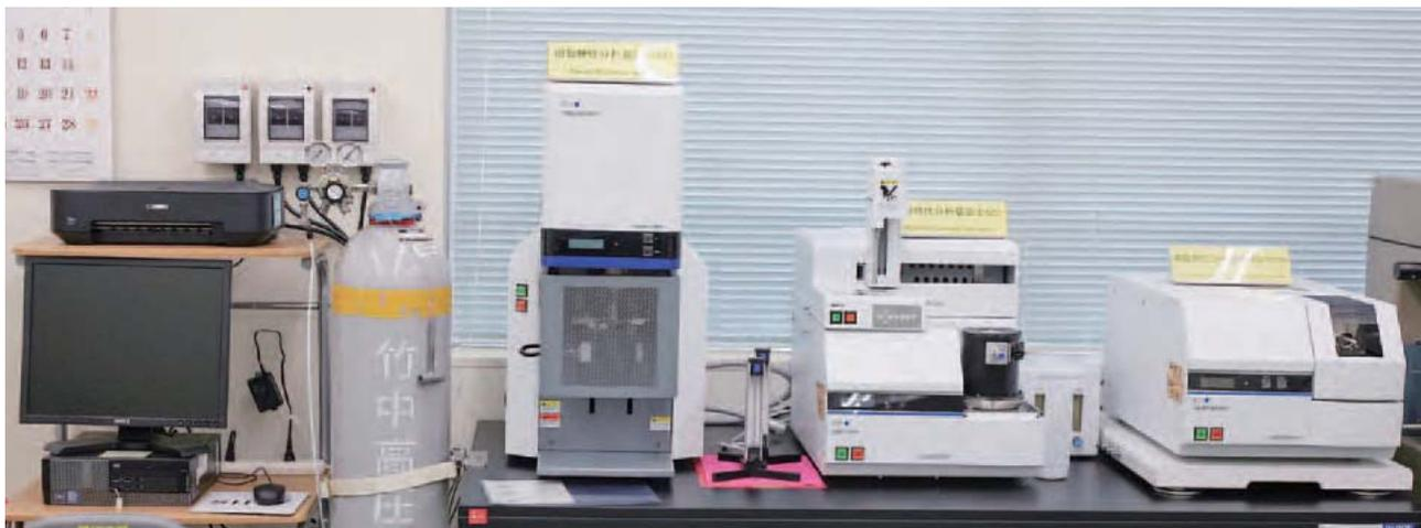
図4 各装置の外観(左から解析用PC、TMA、DSC、TG-DTA)
