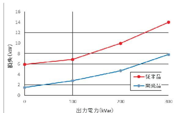
図5 損失測定結果(出力電力対損失)
