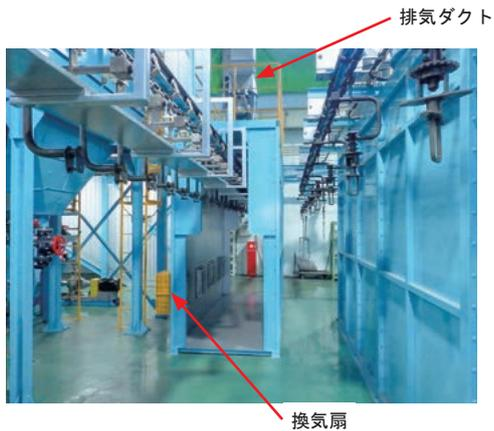
図3 送風式冷却装置
