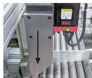
1.手前のパイプ材を転がらないように抑える
