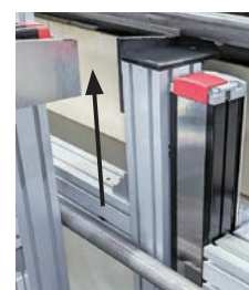
2.パイプ材を上昇させる
