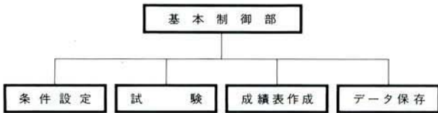
図8/プログラムの基本構成 Fig. 8/Basic structure of test system program
