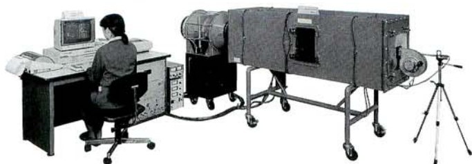
図10/ファン風量自動計測システム外観 Fig. 10/Automatic test system for fan characteristics
