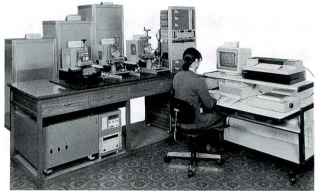
図4/小形モータ負荷特性自動計測システム外観 Fig. 4/Automatic test system for load characteristics of the small motors
