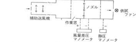
(a) マルチノズル式ファン風量測定装置 Multi-nozzle type characteristics measurement unit
