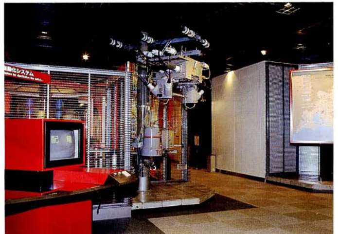
● 電気文化会館に展示中の 配電線自動化用真空開閉器並びに電源用変圧器
